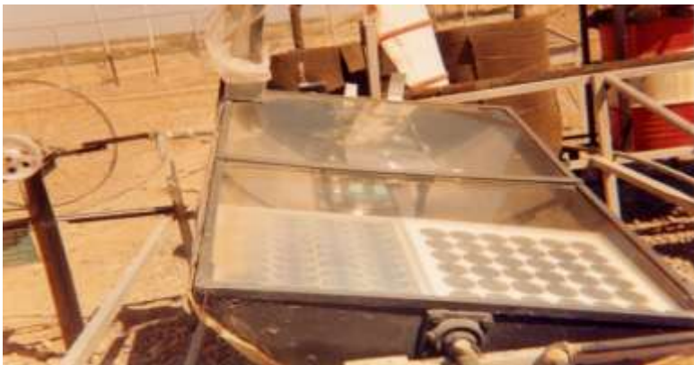
FIGURA 21. Sistema de seguimiento automático del sol y de transmisión de movimiento a los colectores cilíndrico – parabólicos
