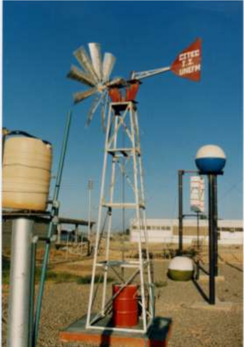
FIGURA 13. Aerobomba multipala construida e instalada en el Laboratorio de Energías No Convencionales CITIP, UNEFM Punto Fijo, Estado Falcón.
