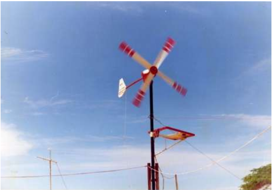
FIGURA 2. Generador híbrido eólico solar de 1,5 kW de potencia nominal
