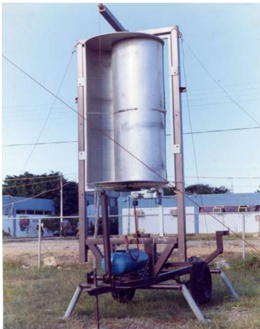
FIGURA 17. Aerobomba Savonius por compresión de aire construida en el Laboratorio de Energías No Convencionales del CITIP
