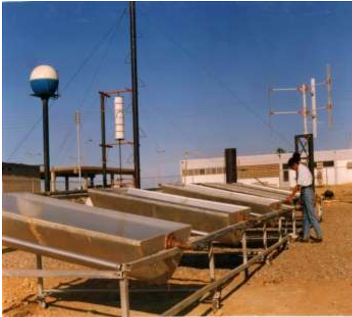
FIGURA 19. Banco de colectores cilíndricos – parabólicos instalados enserie, Laboratorio de Energía No Convencionales CITIP/UNEFM
