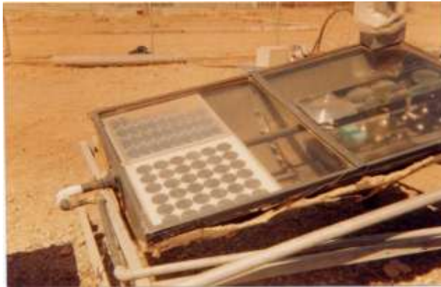
FIGURA 20. Sistema de circulación y Calentamiento de Aceite con Lupas Ópticas y Fresnel
