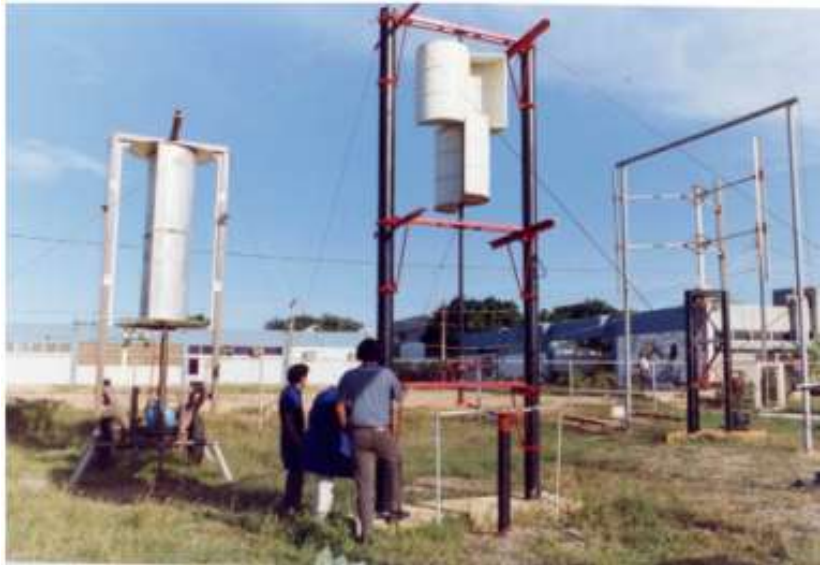
FIGURA 16. Aerobomba Savonius con doble perfil aerodinámico desplazado 90 °
