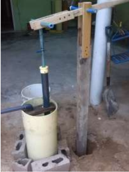
FIGURAS 55 a, b, c y d. Sistema de bombeo para la obtención de agua del subsuelo en la comunidad costera del Supí, municipio Falcón del Estado Falcón/Venezuela.
