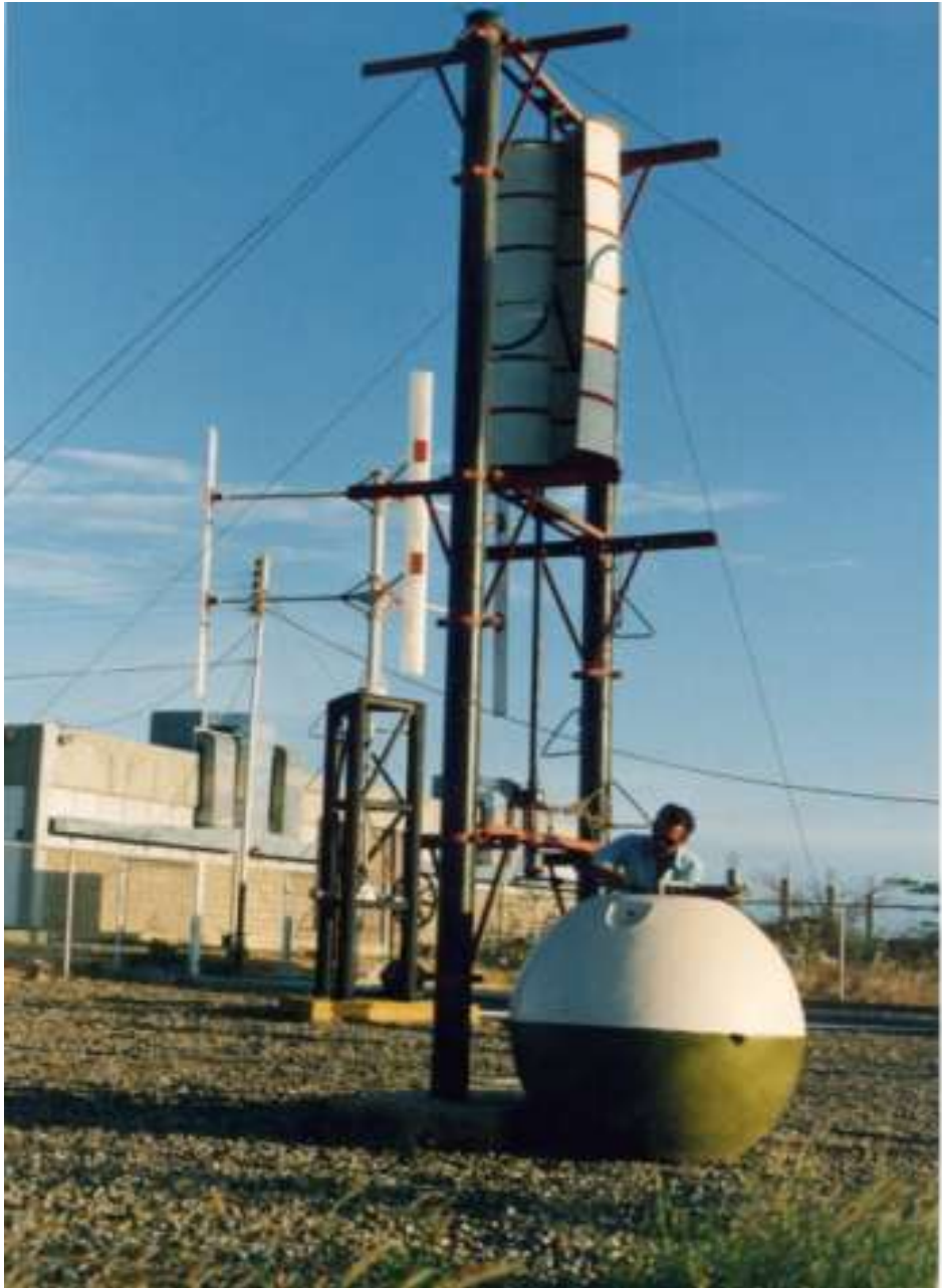
FIGURA 15. Aerobomba Savonius construida con recipientes de aceite donde se pueden observar detalles de la torre de sustentación y los soportes de la turbina
